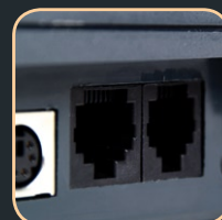
bezpośrednie podłączenie wagi, czytnika kodów kreskowych, komputera i szuflady
